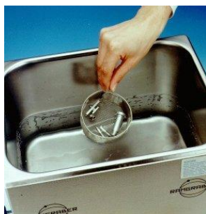
Bild: Reinigung von Dispensernadeln mit ZESTRON® ES 200 in US-Schwingwanne
